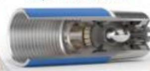
Для предотвращения заполнения спускаемой обсадной колонны буровым раствором. Используются в наклонно-направленных и горизонтальных скважинах, выполнения функции «Стоп» для посадки разделительных пробок в процессе закачивания тампонажного раствора.
