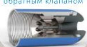
Для оборудования низа обсадных колонн с целью направления их по стволу скважины и защиты от повреждения при спуске в скважину. Состоит из прочного стального корпуса и соединенной с ним полусферической бетонной насадки. Легко поддается разбурированию.
