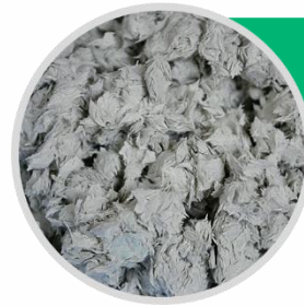
BMC (Bulk Molding Compound) 緩い形のない質量の形で材料
