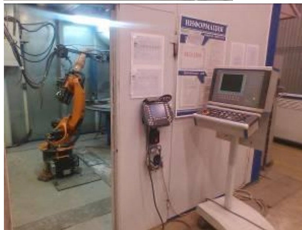
Ионно-плазменное и плазменное напыление уплотнительных, жаростойких, теплозащитных и износостойких покрытий
