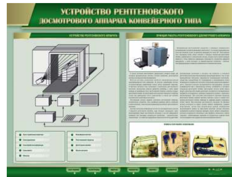
Стенд электрифицированный «УСТРОЙСТВО РЕНТГЕНОВСКОГО ДОСМОТРО- ВОГО АППАРАТА КОНВЕЙЕРНОГО ТИПА»
