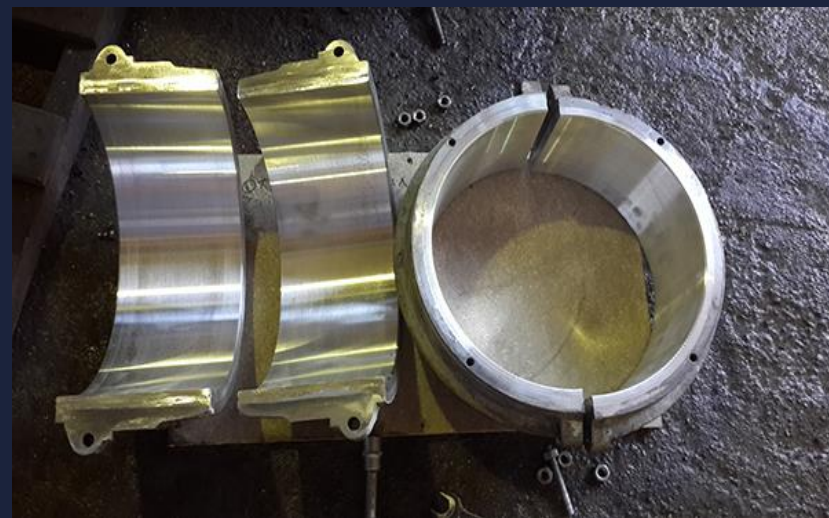
Восстановленные подшипники с покрытием баббитом
