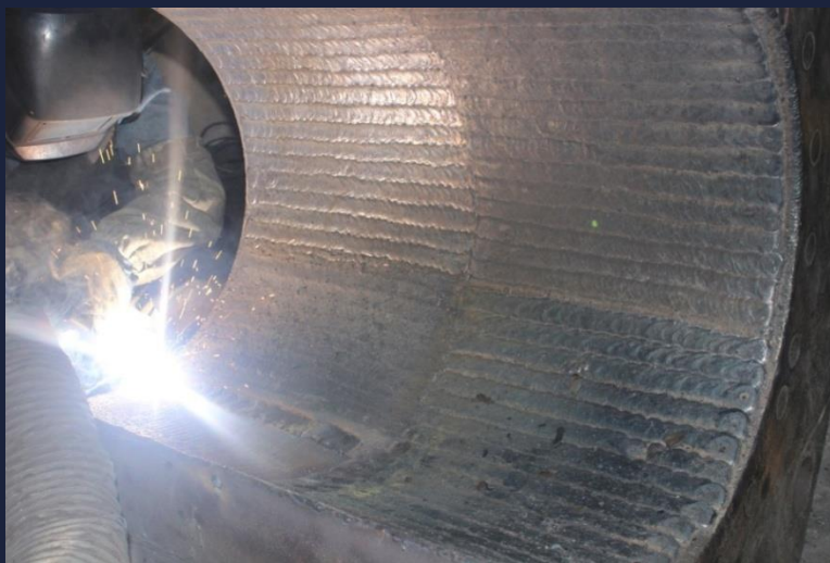
Наплавка внутренней поверхности полукамеры
