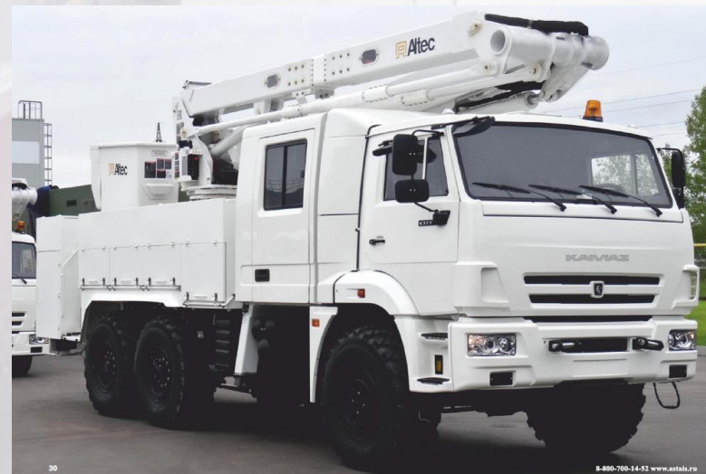
Мобильный подъемник с рабочей платформой 653451 на шасси КамАЗ 43118
