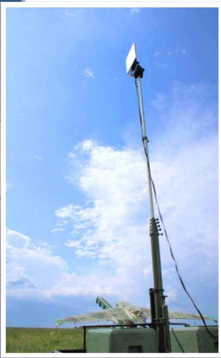
Выдвижной антенный модуль на прицепе
