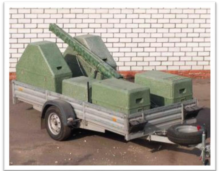
Прицеп с закрепленной пневмокатапульты и контейнерами
