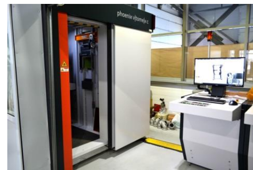
КОМПЬЮТЕРНЫЙ РЕНТГЕН ТОМОГРАФ GE PHOENIX V(TOME) XC 450
