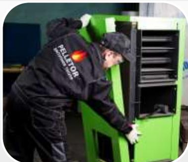
**Котёл в сборе с теплоизоляционными панелями и дверками**
