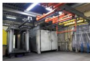
Ярымавтомат порошок сиптереп буяу линиясе
