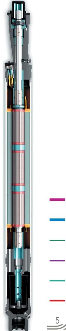
**水力発電の保護**は ED 形成流体圧油漏れと熱的变化を補うために、孔内部空洞の圧力の同等化のため ED 浸漬内部の空洞形成流体浸透から保護するものボリュームをオイルし、ポンプ軸から軸力の知覚の ED を停止する。
