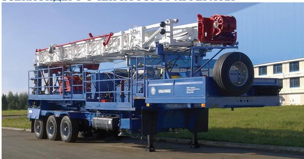
Агрегат әйләнә-тирә мохиттәге һава температурасы  $-45^{\circ}\text{C}$  алып  $+40^{\circ}\text{C}$  кадәр тәшкит иткән уртача климатлы макроклимат районнарында нефть һәм газ скважиналарын үзәкләштерү, капитал һәм жир астында төзекләндерү өчен билгеләнгән.
