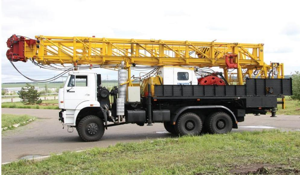
Агрегат әйләнә-тирә мохиттәге һава температурасы  $-45^{\circ}\text{C}$  алып  $+40^{\circ}\text{C}$  кадәр тәшкит иткән уртача климатлы макроклимат районнарында нефть һәм газ скважиналарын төзекләндерү һәм үзәкләштерү өчен билгеләнгән.
