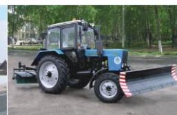
Буьдозерный передний отвал. Щеточное устройство ЩУ-2,0
