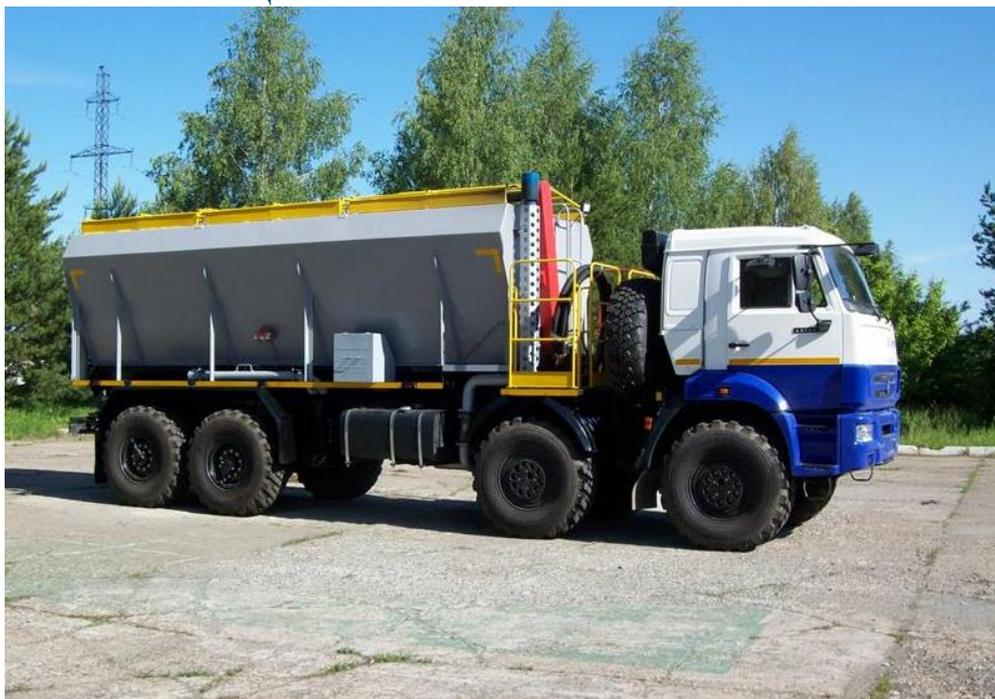
Коры порошоксыман материалларны (цемент, тампонаж катнашмалар һ.б.) транспорт белән күчерү, әлеге материалларны шөрөпле конвейерлар (шнеклар) белән тапшыруны механик жайга салу һәм нефть һәм газ скважиналарын цементизацияләгәндә тампонаж катнашмаларын эзерләү өчен билгеләнгән.
