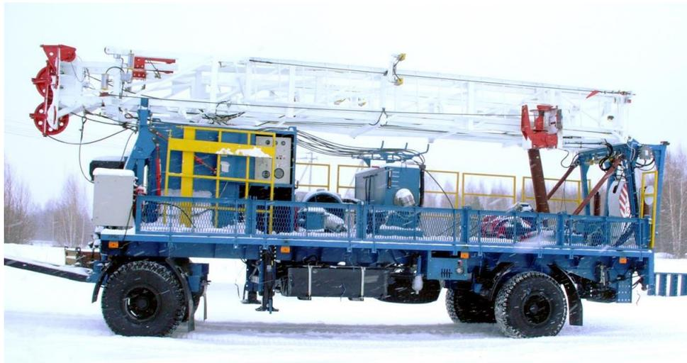
Скважиналарны ремонтлау өчен АПРС-12 күтәртмә агрегаты (алга таба – агрегат) мачтаны жайга салу һәм үзәкләштерү, үзәктән кудыручы батырма насосларны, штангалы шөрөпле насосларны төшерү-күтәртү мөмкинлеге белән скважиналарга капитал ремонт уздыру өчен билгеләнгән.
