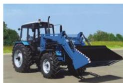
Погрузочное устройство с ковшем 0,8м<sup>3</sup> и с вилочным захватом
