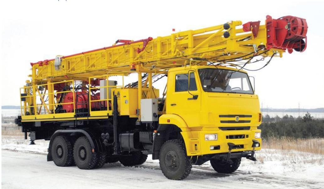
Агрегат әйләнә-тирә мохиттәге һава температурасы  $-45^{\circ}\text{C}$  алып  $+40^{\circ}\text{C}$  кадәр тәшкит иткән уртача климатлы макроклимат районнарында нефть һәм газ скважиналарын үзекләштерү, капитал һәм жир астында төзекләндерү өчен билгеләнгән.
