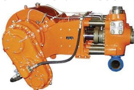
Скважиналарны цементацияләү өчен билгеләнгән һәм АЦ-32 агрегатларында кулланыла.
