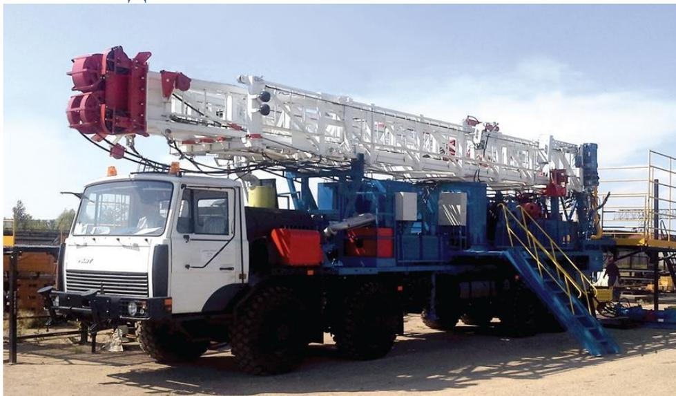
Агрегат әйләнә-тирә мохиттәгә һава температурасы  $-45^{\circ}\text{C}$  алып  $+40^{\circ}\text{C}$  кадәр тәшкит иткән уртача климатлы макроклимат районнарында нефть һәм газ скважиналарын төзекләндерү һәм үзәкләштерү өчен билгеләнгән.
