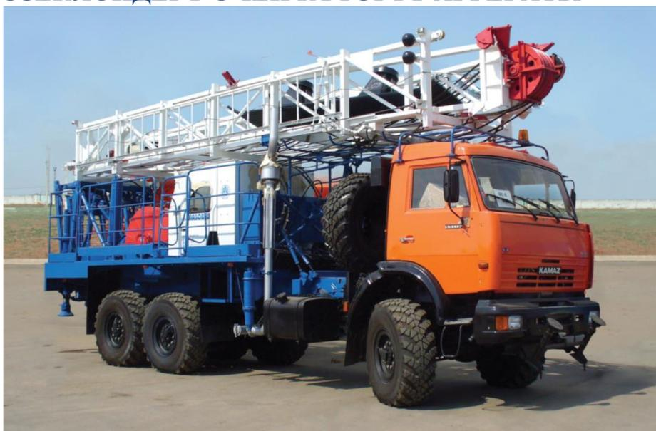
Агрегат әйләнә-тирә мохиттәге һава температурасы  $-45^{\circ}\text{C}$  алып  $+40^{\circ}\text{C}$  кадәр тәшкит иткән уртача климатлы макроклимат районнарында нефть һәм газ скважиналарын жиһир астында төзекләндерү һәм үзекләштерү өчен билгеләнгән.
