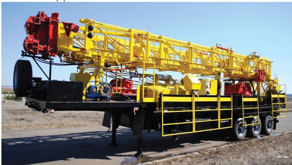
Агрегат эйләнә-тирә мохиттәге һава температурасы  $-45^{\circ}\text{C}$  алып  $+40^{\circ}\text{C}$  кадәр тәшкит иткән уртача климатлы макроклимат районнарында нефть һәм газ скважиналарын төзекләндерү, үзекләштерү һәм бораулау өчен билгеләнгән.
