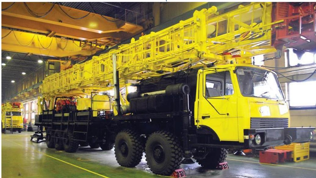
Әйләнә-тирәлекнең һава торышы  $-45^{\circ}\text{C}$  башлап  $+40^{\circ}\text{C}$  кадәр тәшкил иткән уртача климатлы макроклимат районнарында 2500 м (колонна массасы 24 кг/м булганда) тирәнлектә скважиналарны ротор һәм забой двигательләре белән бораулау, 5000 м (НКТ 14кг/м) кадәр тирәнлектә нефть һәм газ скважиналарын капитал төзекләндерү, үзәкләштерү һәм торгызу өчен билгеләнгән.
