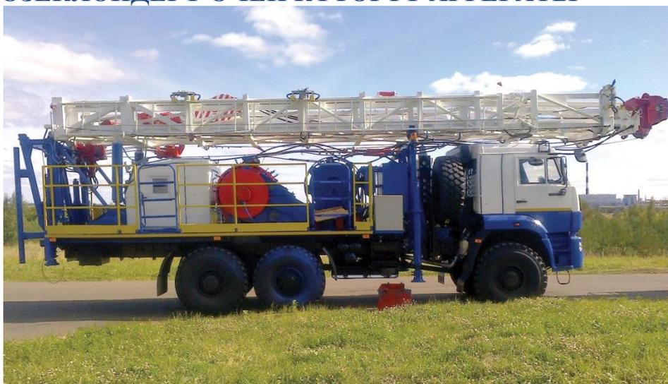
Агрегат әйләнә-тирә мохиттәге һава температурасы  $-45^{\circ}\text{C}$  алып  $+40^{\circ}\text{C}$  кадәр тәшкит иткән уртача климатлы макроклимат районнарында нефть һәм газ скважиналарын үзәкләштерү, капитал һәм жир астында төзекләндерү өчен билгеләнгән.
