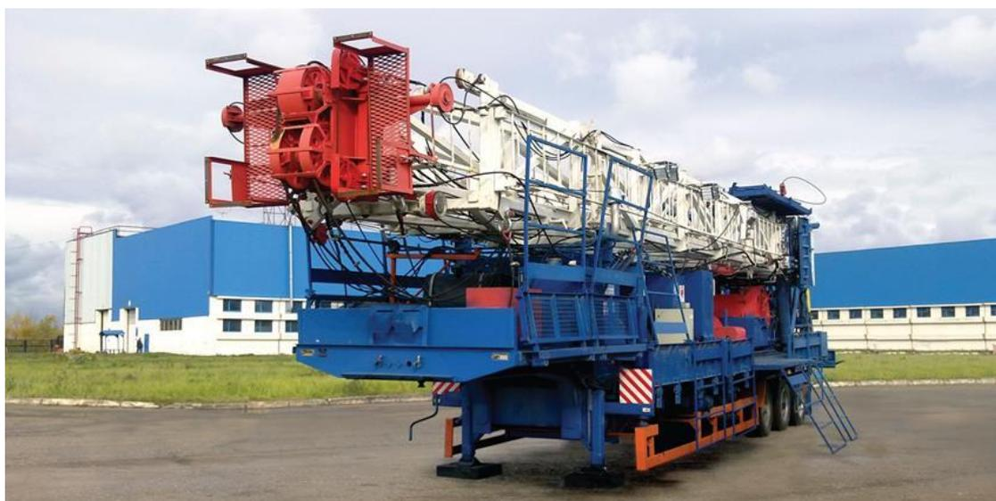
Әйләнә-тирәлекнең һава торышы  $-45^{\circ}\text{C}$  башлап  $+40^{\circ}\text{C}$  кадәр тәшкил иткән уртача климатлы макроклимат районнарында 2500 м (колонна массасы 24 кг/м булганда) тирәнлектә скважиналарны ротор һәм забой двигательләре белән бораулау, 5000 м (НКТ 14кг/м) кадәр тирәнлектә нефть һәм газ скважиналарын капитал төзекләндерү, үзәкләштерү һәм торгызу өчен билгеләнгән.
