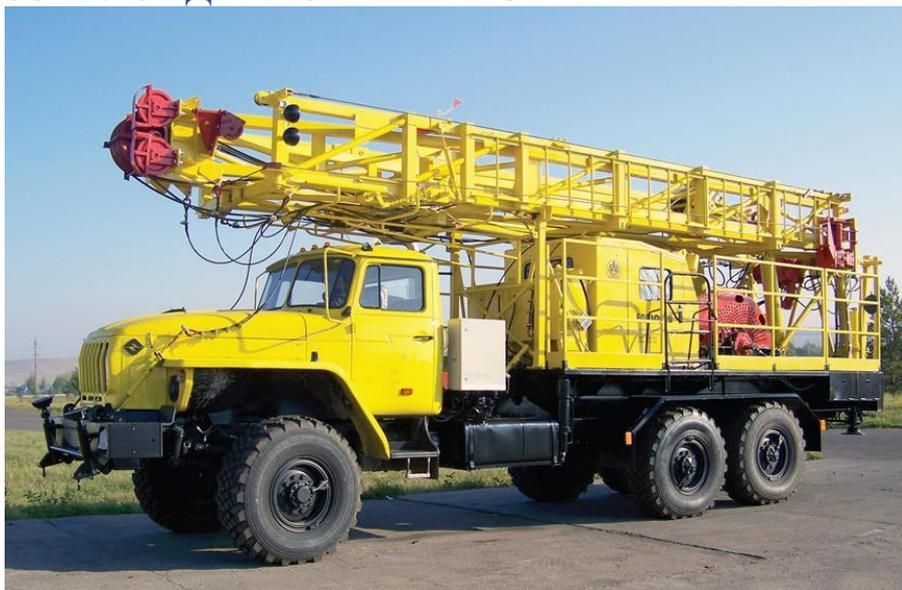
Агрегат эйләнә-тирә мохиттәге һава температурасы  $-45^{\circ}\text{C}$  алып  $+40^{\circ}\text{C}$  кадәр тәшкил иткән уртача климатлы макроклимат районнарында нефть һәм газ скважиналарын жир астында төзекләндерү һәм үзәкләштерү өчен билгеләнгән.
