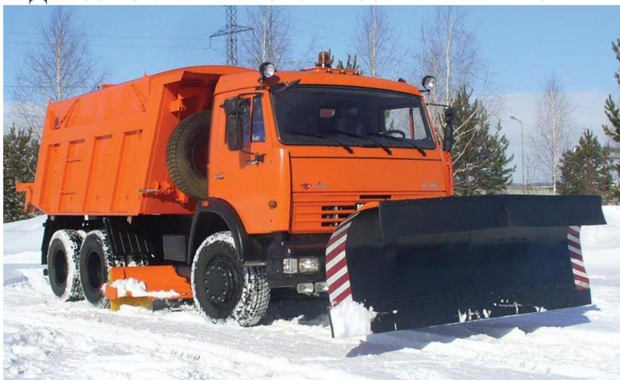
КАМАЗ автомобиле базасында универсаль юл машинасы ел әйләнәсе автомобиль юлларына хезмәт күрсәтү өчен билгеләнгән:
