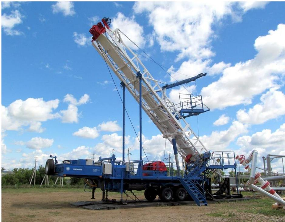
Агрегат авызы жир өслегенә чагыштырмача 45°- 75° почмагында урнашкан скважиналарны жир астында ремонтлау, шул исәптән  $\varnothing 22, 25$  мм тирәнлек-насос штангалары һәм  $\varnothing 48, 60, 73, 89$  мм насос-компрессор трубалар (НКТ) белән төшерү-күтәртү операцияләрен башкару, штангаларны һәм трубаларны механик рәвештә гидравлик ачыкыч кулланып борып кертү һәм борып чыгару, фонтан арматурасын һәм нефть-газ скважиналарын герметиклау жайланмаларын монтажлау-демонтажлау өчен билгеләнгән.
