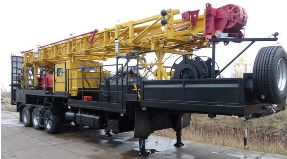
Агрегат әйләнә-тирә мохиттәге һава температурасы  $-45^{\circ}\text{C}$  алып  $+40^{\circ}\text{C}$  кадәр тәшкит иткән уртача климатлы макроклимат районнарында нефть һәм газ скважиналарын үзекләштерү, капитал һәм жир астында төзекләндерү өчен билгеләнгән.
