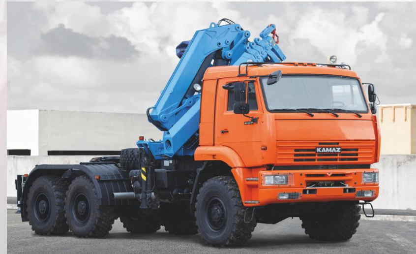
Sattelschlepper mit Kran-Manipulator auf dem Fahrgestell KamAS 65225
