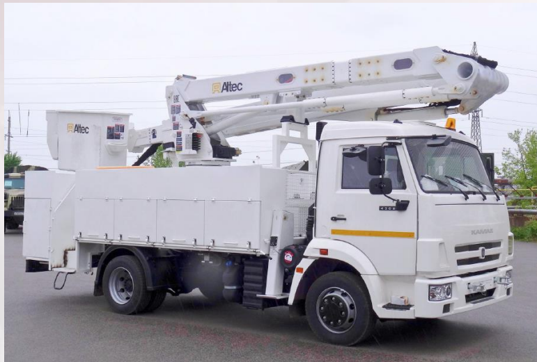
Elevador móvil con plataforma de trabajo 653450 en el chasis del KamAZ 4308
