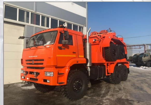
Enrollador de tuberías pesadas Con salida de remolque
