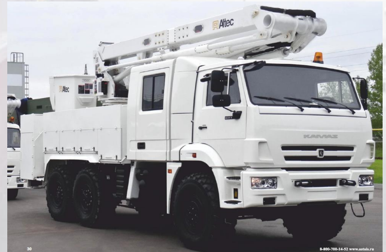
Elevador móvil con plataforma de trabajo 653451 en el chasis del KamAZ 43118
