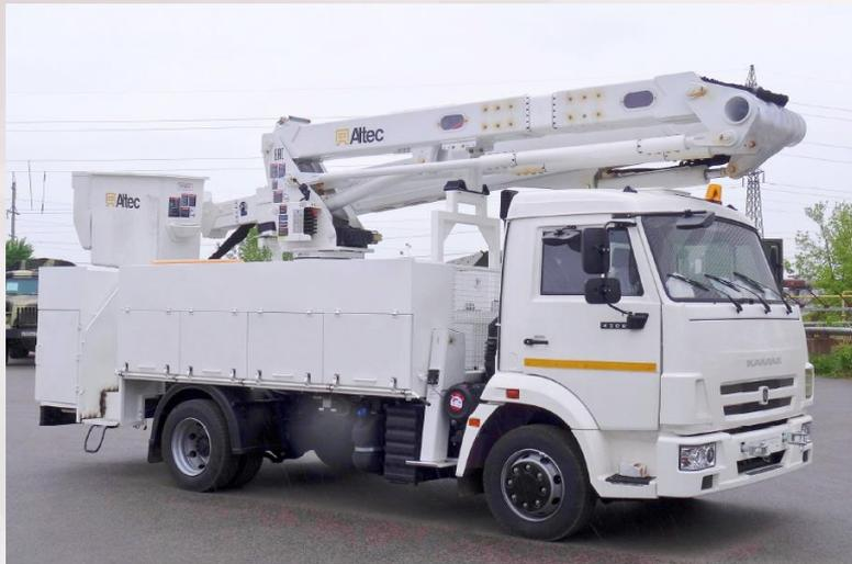
L'élévateur mobile muni de la nacelle
