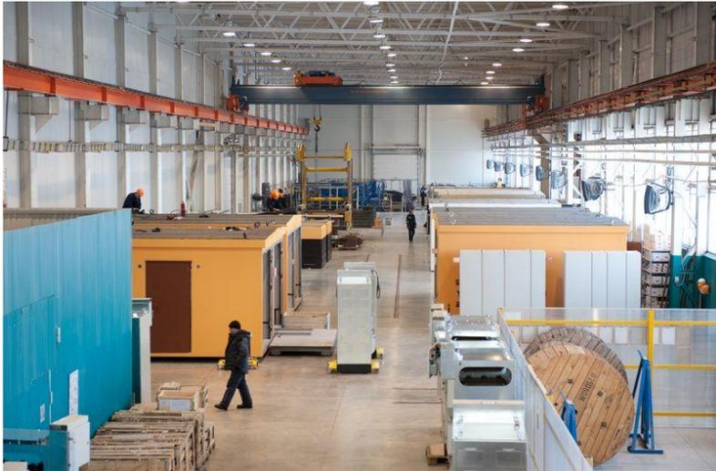
La capacité de production atteint 75 des postes de transformation de sous-tirage préfabriqué, des salles des machines par mois;
