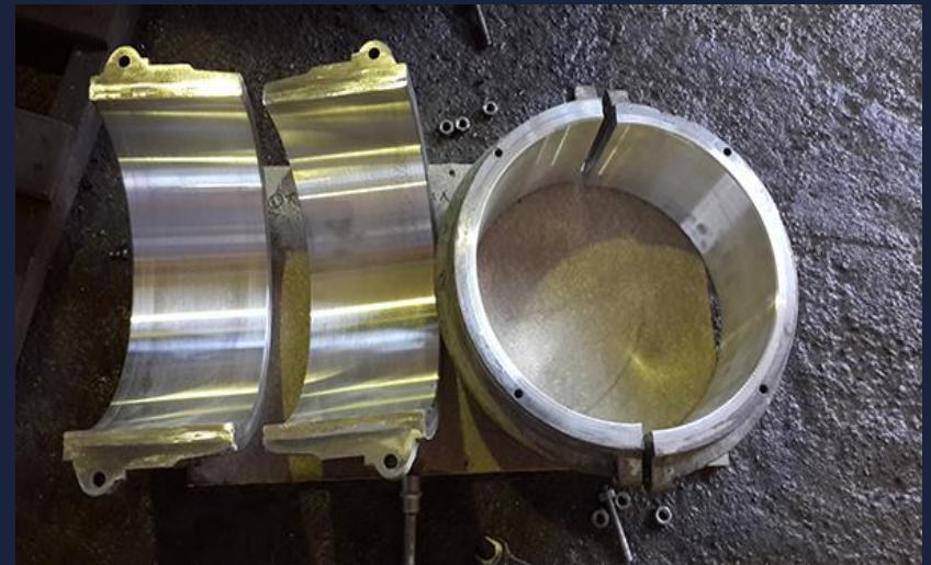
Les paliers restaurés avec le revêtement d'alliage blanc
