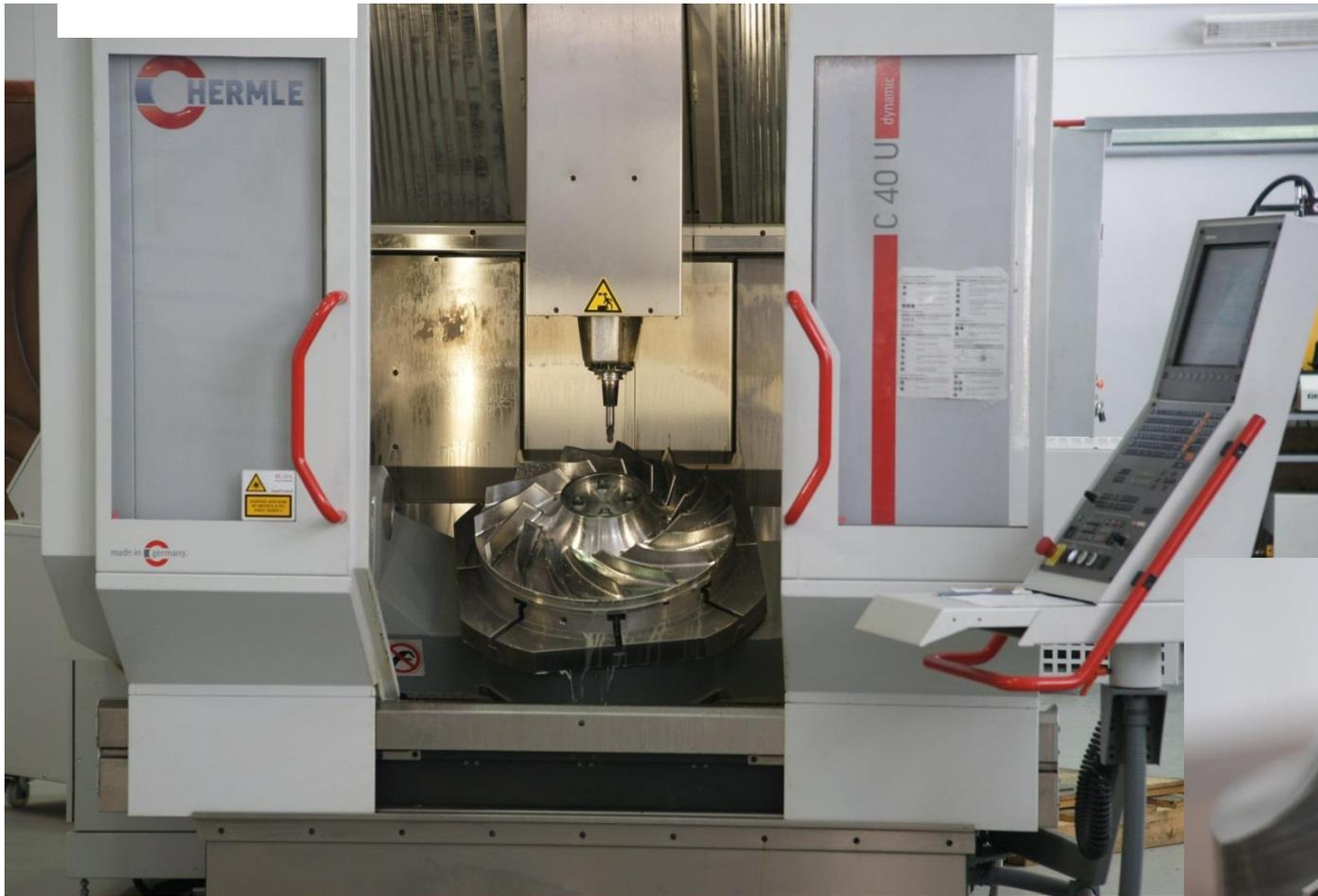
Pour le fraisage des roues avec les ailettes spatiales on a créé l'endroit d'usinage à cinq coordonnées sur lequel fonctionnent les machines C40U Dynamic produit par la firme "Hermle" (l'Allemagne).
