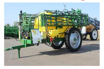
حجم الخزان الرئيسي، لتر 3 000 4 000 عرض الشريط، متر 24: 28 ارتفاع شريط تعديل، سم 50 - 200خزان إضافي مخصص للمياه التقنية، لتر 300 خز ان لغسل البدين، لتر 20 خزان إضافي للمحلول، لتر 35 القدرة الإنتاجية للمضخة، لتر / دقيقة 200 الارتفاع عن الأرض، سم 75 رؤوس الرش، قطعة 48 - 56مسار قابل للتعديل، متر 1.4: 1.6: 1.8 الأبعاد الكلبة، متر 6 x 2.4 x 2.4 الوزن، كجم 2 000 2 050 يتم تجميعها مع الجرارات من فئة 1,4; 2
