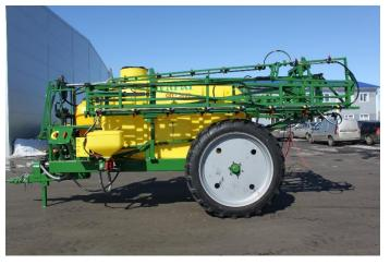
صمم للحماية الكيميائية لمختلف النباتات. في المعدات القياسية، جهزت الآلة بالكامل هيدر وليكيا (من الممكن تسليم الآلات ذات الطي الميكانيكي لذراع الرافعة) المحاور المنزلقة للعجلات 1.4-1.8 متر وويبلغ الارتفاعن عن الأرض 70 سم يوفران تنوعًا عند معالجة مختلف المحاصيل. تتميز الرشاشات بإطار مقوى وبذراع معزز بوحدة تخميد فعالة ، ومعدات هيدر وليكية إيطالية ودعم وسيط أمام المضخة. يتميز مؤشر مستوى الحل في الخزان الرئيسي بمقياس مع حالات التخرج التي تظهر بوضوح من مقصورة الجرار. مجمعة مع الجرارات فئة بيطار.
