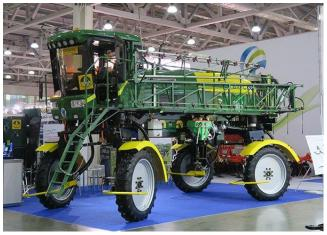
خصص للحماية الكيميائية لمختلف النباتات وإدخال الأسمدة المعدنية السائلة عن طريق الرش السطحي. هذا هو مزيج مثالي من الراحة وسهولة الإدارة والتكنولوجيا الحديثة. تعد هذه الآلة ذات الارتفاع الأرض المرتفع خيارًا ممتازًا لتطبيق المواد الكيميائية والأسمدة السائلة في أي مرحلة من مراحل دورة حياة النباتات.
