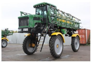
مع 4000-SOتوفر آلة الرش بدفع رباعي ناقل حركة هيدروليكي حركة واثقة من خلال الحقول الثقيلة للغاية، وسهولة المنعطفات وعند القيام بالمناورات، وذلك بفضل أوضاع التشغيل باستخدام عجلتي قيادة وأربع عجلات قيادة ودورة كراب.
