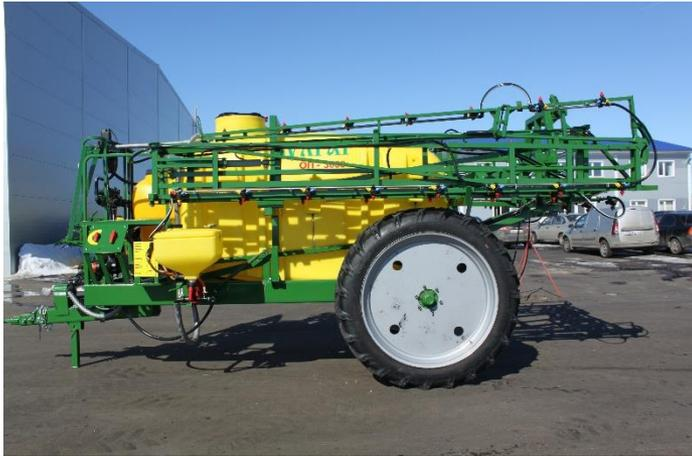
保加尔牵引式喷雾器用于各种植物的化学防护。标准配置的喷雾器是完全液压传动的（有带有杆的机械折叠的功能的机器的供应的可能性）。轮子的能拉开的1,4-1,8米的轴和70米的离地间隙保证在各种农作物的加工中具有多功能性。喷雾器的特点是加固的机架和带有有效的缓冲组合件的加固的杆，意大利液压设备和泵前的中间支撑。主油箱中的溶液液位指示器具有一个从拖拉机驾驶室中清晰可见的刻度。与拖拉机1, 4类联成机组。
