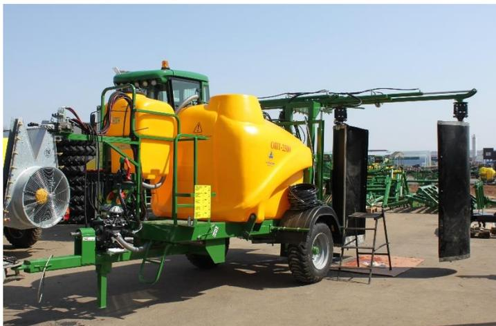
在经常有风的天气的条件下，隧道式喷雾有助于在高度2.2米以下的树木的叶子上施用农药的最大程度的效率。风对喷雾液的体积和渗透的有害影响是葡萄加工中的众所周知的问题。
