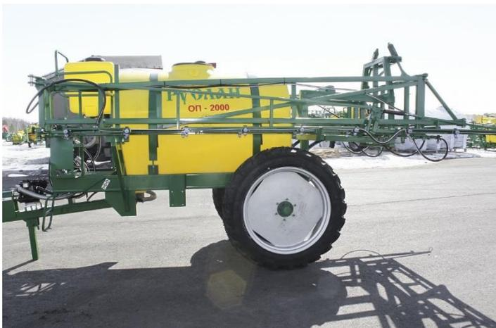
喷雾器用于各种植物的化学防护。标准配置的喷雾器是完全液压传动的（有带有杆的机械折叠的功能的机器的供应的可能性）。修定的设计和最低的成本使这些机器成为俄罗斯联邦最常见的机器。轮子的能拉开的1,4-1,8米的轴和70厘米的离地间隙保证在各种农作物的加工中具有多功能性。喷雾器的特点是加固的机架和带有有效的缓冲组合件的加固的杆，意大利液压设备和泵前的中间支撑。主油箱中的溶液液位指示器具有一个从拖拉机驾驶室中清晰可见的刻度。与拖拉机1,4类联成机组。
