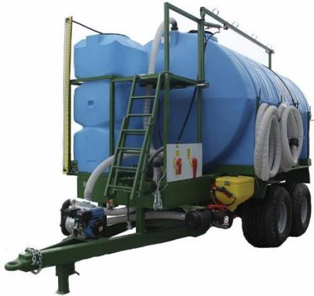
运输用的联合混料机用于为各种农作物的化学保护准备溶液，并将准备好的液体快速泵入喷雾器。
