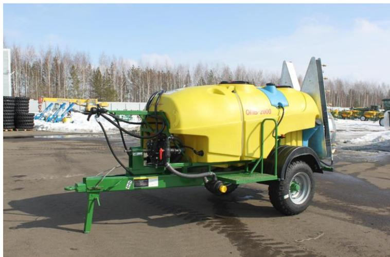
OPV-2000喷雾器用于果园中的多年生高大的植物的化学保护以及通过使用定向气流的表面喷雾的方式来处理葡萄园和浆果园免受病虫害。
