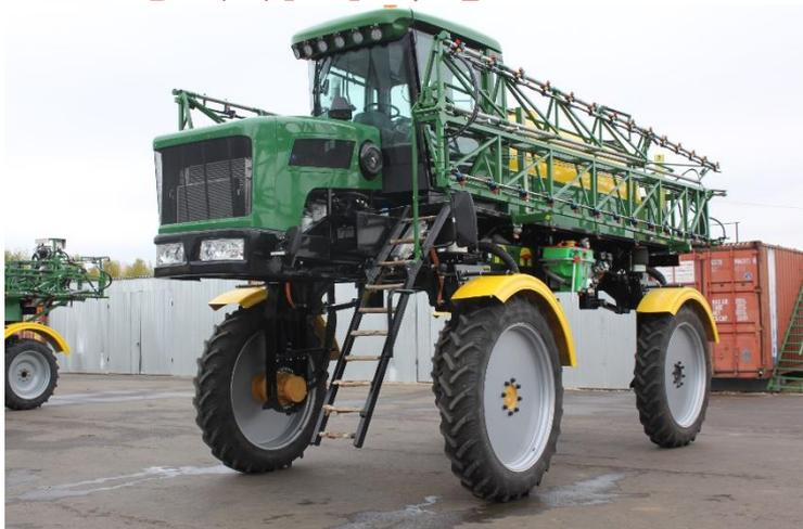
带有液体传动OS-4000全轮驱动自走式喷雾器，由于具有两个、四个主动轮的模式以及螃蟹式运行，该喷雾器保证早非常困难的田地上的可靠的移动、易于转弯和执行机动。
