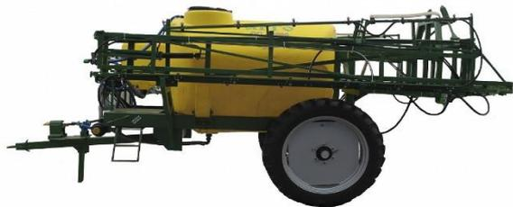
喷雾器用于各种植物的化学防护。标准配置的喷雾器是完全液压传动的（有带有杆的机械折叠的功能的机器的供应的可能性）。
