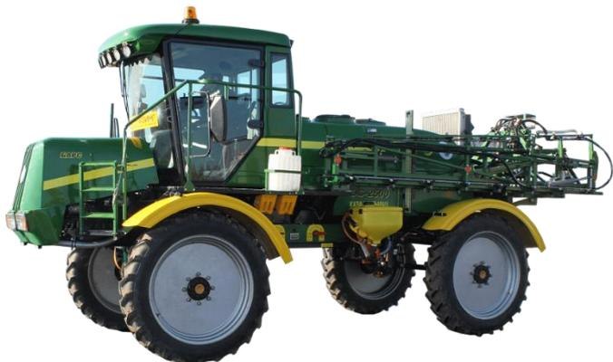
带有液体传动OS-2500全轮驱动自走式喷雾器，该喷雾器保证早非常困难的田地上的可靠的移动、易于转弯和执行机动。
