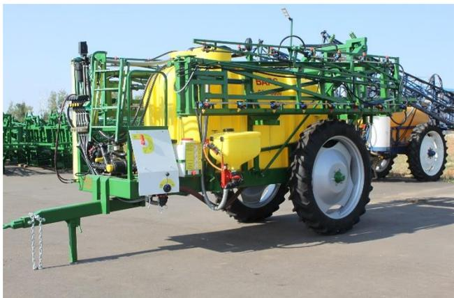
用于各种植物的化学防护及上液态矿物肥料。巴尔斯系列的牵引式喷雾器是完全液压传动的，有2种型号被出产：带有3000公升的容量和带有4000公升的容量。杆的收获的宽度为24米或28米。机器完全类似于国外制造商的牵引式喷雾器，并且在采用其时的经济效率超过国外的设备。巴尔斯系列OS-3000和4000牵引式喷雾器
