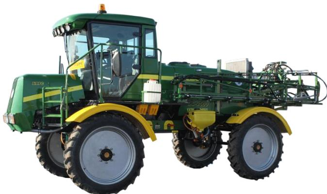
A 4 roues, le pulvérisateur autoporteur OS-2500 à la transmission hydrostatique assurant la course sûre à travers les champs exceptionnellement lourds, la facilité de tournage et à manoeuvrabilité.
