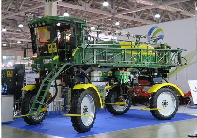
Le pulvérisateur à haute performance est vise à la protection chimique des plantes variées et l'apport des engrais minéraux liquides par la pulvérisation superficière. C'est la combinaison idéale du confort, de la facilité de la commande et des technologies modernes. Cette machine à la haute garde au sol représent l'option idéale afin de l'apport des agents chimiques et des engrais liquides à n'importe quelle étape du cycle de vie d'une plante.
