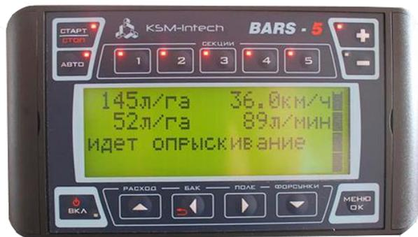
"Bars-5" – le système nécessaire à l'apport uniforme et automatique des agents liquides, vise aux pulvérisateurs à tiges, à la remorque et autoporteur. Installé dans la cabine de l'ensemble.
