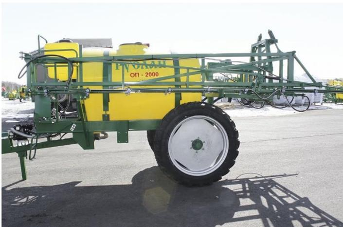
Visés à la protection chimique des plantes chimiques, ainsi que de l'apport des engrais minéraux. Les pulvérisateurs à la remorque de la série "Bars" sont complètement hydraulique (la fourniture des machines au repliage-dépliage mécanique de la tige).
