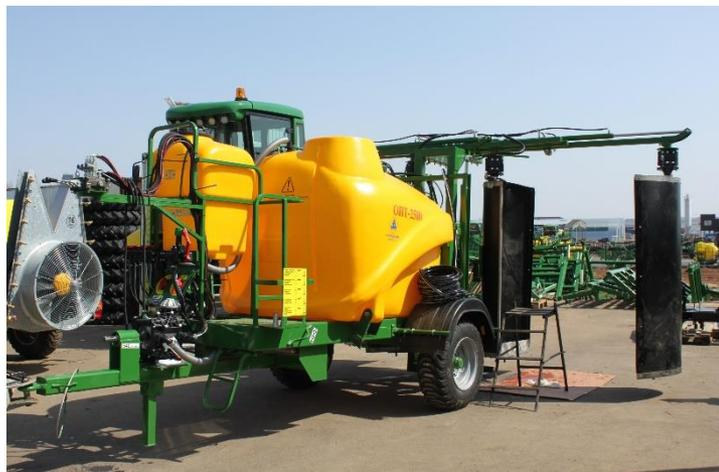
Dans les conditions des vents fréquents, le type de tunnel de la pulvérisation va aider à gagner l'efficacité maximale de l'apport des agents chimiques agricoles sur le feuillage des arbres de la hauteur de jusqu'à 2.2 m. L'attaque du vent sur le volume et la pénétration de la liquide à pulvériser c'est le problème connu au traitement des vignes.
