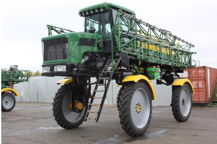
Le pulvérisateur autoporteur à quatre roues motrices OS-4000 à la transmission hydraulique assurant la course sûre à travers les champs exceptionnellement lourds, la facilité de tournage et à manoeuvrabilité, grâce aux régimes de travail à 2 roues motrices, 4 roues motrices, le petit rayon de tournage des roues.
