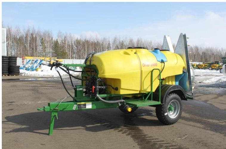
Le pulvérisateur OPV-2000 est vise à la protection chimique de la verdure haute pérennante aux jardins, ainsi que pour le traitement des vignes et des aïrelles des déprédateurs et des maladies par la méthode de la pulvérisation superficière à l'usage du flux d'air dirigé.
