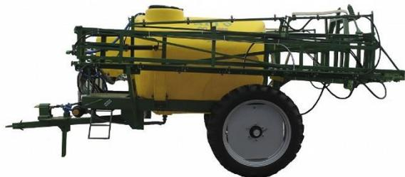
Vises à la protection chimique des plantes chimiques, ainsi que de l'apport des engrais minéraux. Les pulvérisateurs à la remorque de la série "Bars" sont complètement hydraulique (la fourniture des machines au repliage-dépliage mécanique de la tige).
