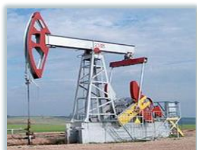
СКН, ПЦ тимер-бетон детальләре
