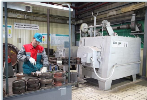
大規模な電気機械のベアリングの修復
