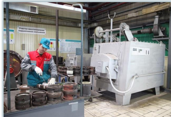
La restauration des paliers de glissement des grandes machines électriques
