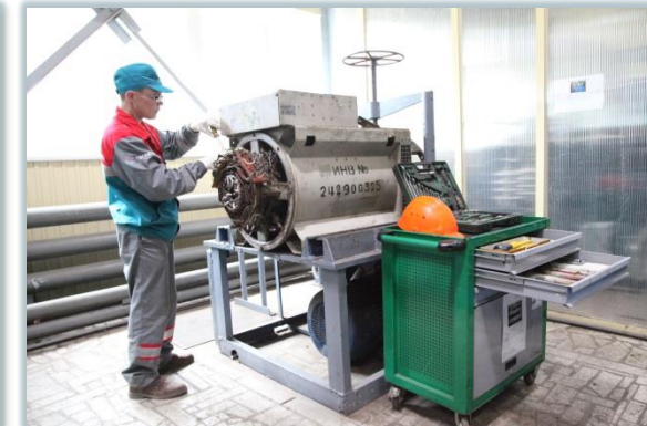
La réparation des générateurs de puissance et de soudage de 0.3 MWt
