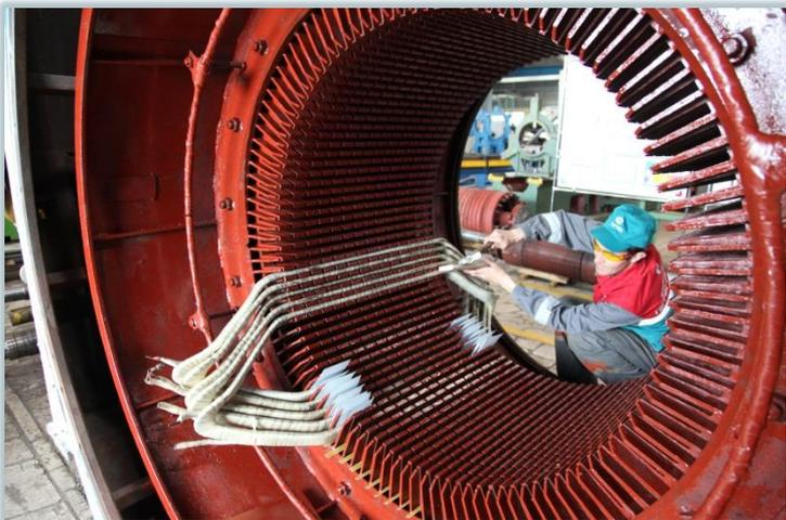
**Elektromotorinstandsetzung bis zu 5 MW**
