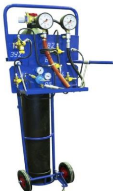
Le banc d'examen des équipements au gaz comprimé et du dégazage
