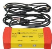
Le diagnostic du système ESI HED-GCUST5.1 pour Euro-5
