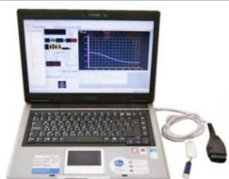
Les matériels à diagnostiquer les systèmes électroniques/le PC portable, le câble IHM, la clé, le logiciel
