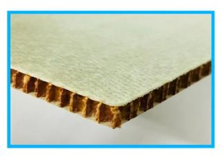
허니콤 센드위치 패널들의 특성 패널들의 두께-5 내지 25 mm 표준 크기- 1220-2440 mm (발주처의 요청에 따라) 패널의 밀도-95 д- 280 кg/m³ 패널의 무게-4,168-7,07 kg
