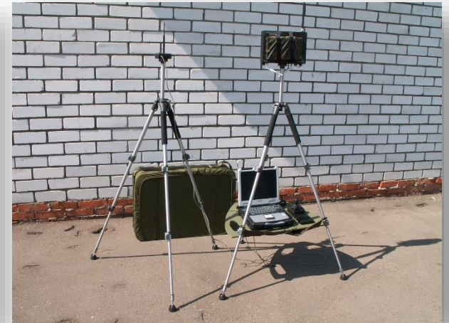
Bedienstation und Antennenmodul
