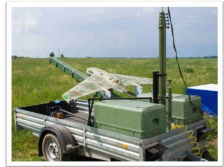
منجنيق لإطلاق الطائرات بدون طيار
