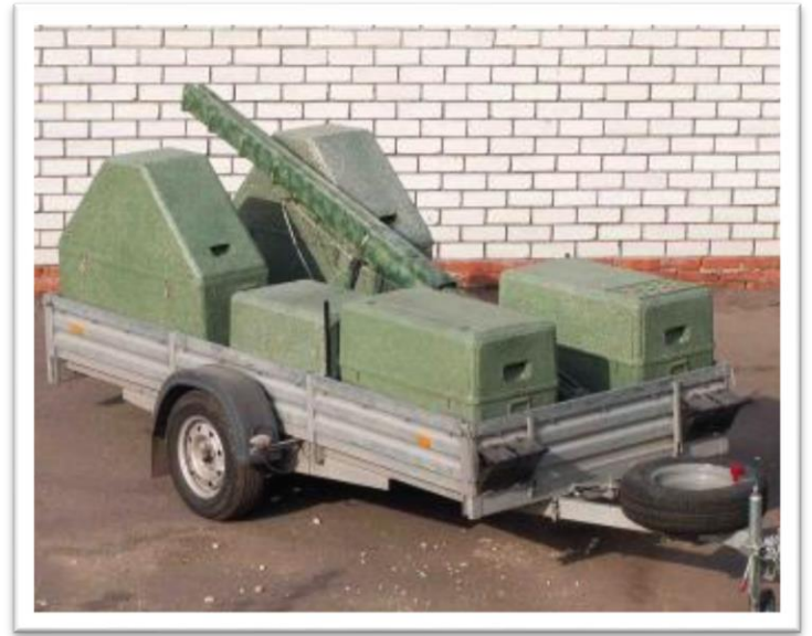
مقطورة مع المنجنيق لإطلاق الطائرات بدون طيار والحاويات
