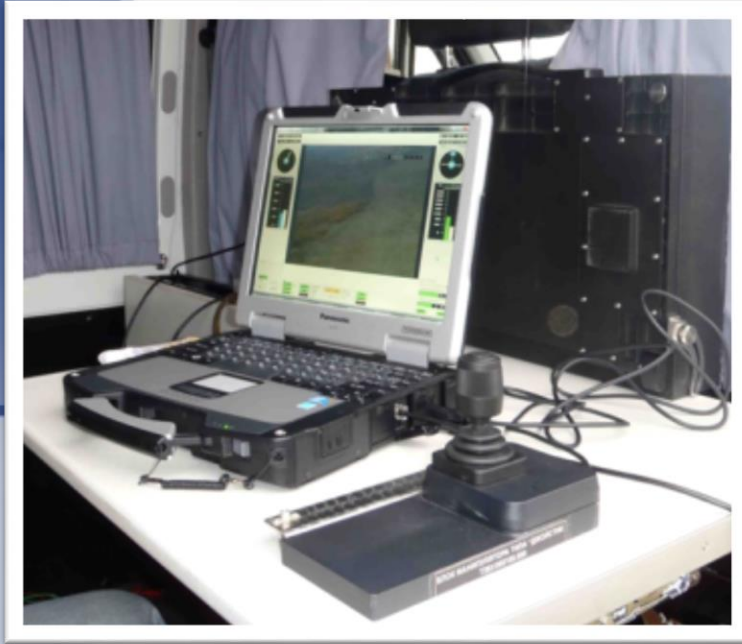
Lugar de trabajo del operador del aparato aéreo no tripulado
