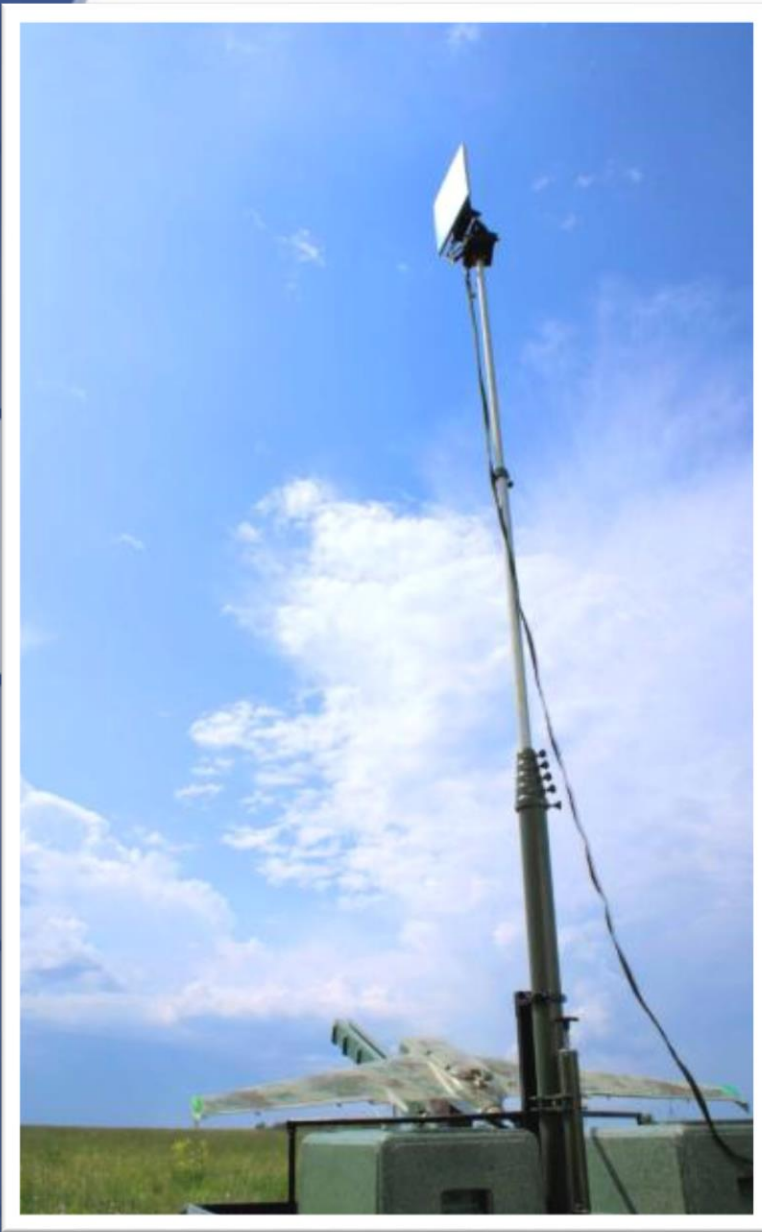
Módulo de antena móvil en el remolque
