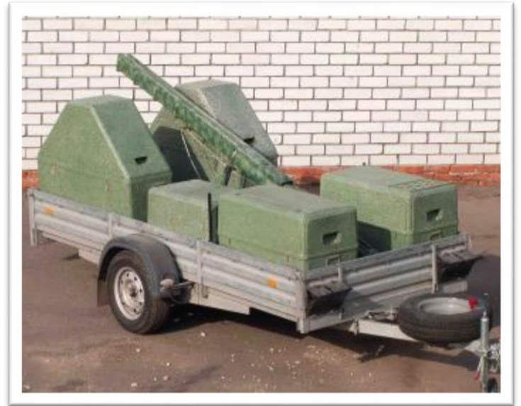
Remolque con catapulta neumática y contenedores fijos
