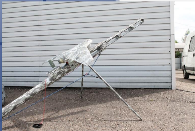
Dispositivo de lanzamiento neumático
