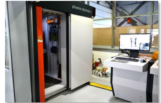
LE BLOC DE RADIOGRAPHIE INFORMATIQUE LE SCANNER "PHOENIX V"(TOME) XC 450
