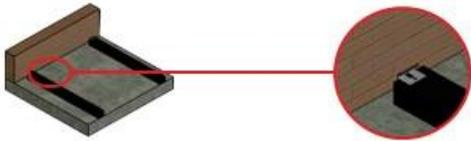
テラスボードの取り付けは敷設ボーディングジョイストから始まります、ボーディングジョイスト間のステップは400 mmを超えてはいけません。支柱の端部には金属製の開始クリップがあり、その溝にテラスボードがストップまで押し込まれています。
