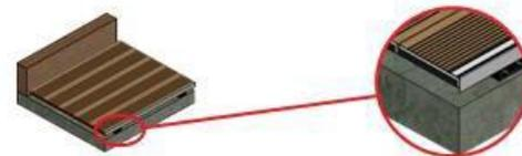
最後のボードもスタートクリップで固定されています。ボードの端はプラスチック製のプラグまたはエンドプレートで閉じられています
