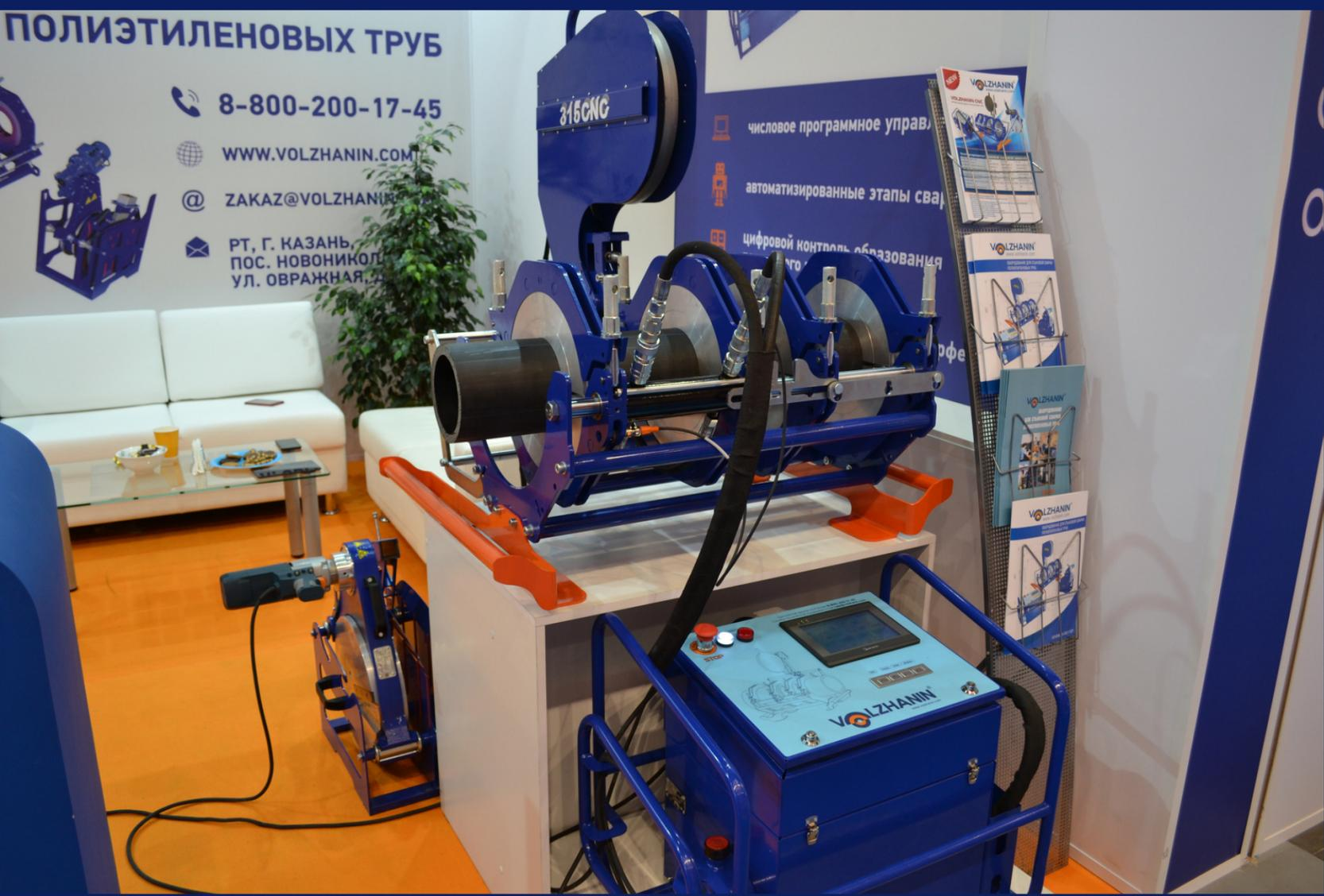
Сварочные аппараты предназначены для контактно-стыковой сварки полимерных труб и диаметром от 40 до 315 мм, а также соединительных деталей из полиэтилена в автоматическом режиме согласно технологии сварочного процесса по ГОСТ Р ИСО 55276-2012.
