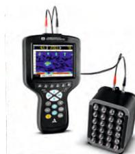
Ультразвуковой дефектоскоп А 1220 Монолит
