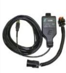
Сканер E-COM системы DBC Евро-4
